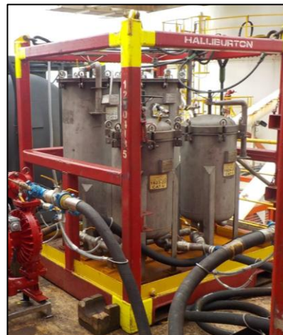
Figura 21: Exemplo de um módulo de tratamento de água com tecnologias de filtração
